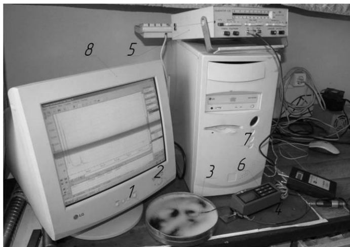
1 – посудина з пружним середовищем; 2 – експериментальний зразок; 3 – п'єзоелемент; 4 – з'єднувальні дроти; 5 – генератор звуковий ЛЗ0; 6 – твердомір; 7 – профілометр; 8 – ЕОМ
