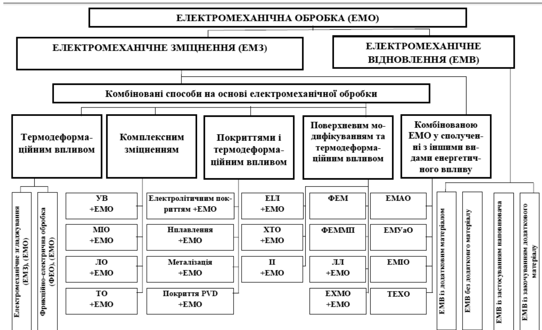
Рисунок 1.1 – Класифікація методів електромеханічного оброблення (ЕМО) і комбінованих методів оброблення на основі ЕМО
