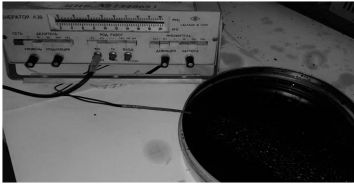
Рисунок 3.40 – Пластина, занурена в пружне середовище
