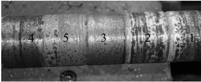
1 – Al_2O_3 + Fe_2O_3 ; 2 – Al_2O_3 + KMnO_4 ; 3 – KMnO_4 + Fe_2O_3 ; 4 – KMnO_4 + C\dot{C}H_0 ; 5 – KMnO_4 + Fe_2O_3 + Al_2O_3 Рисунок 3.51 – Зразок після оброблення
